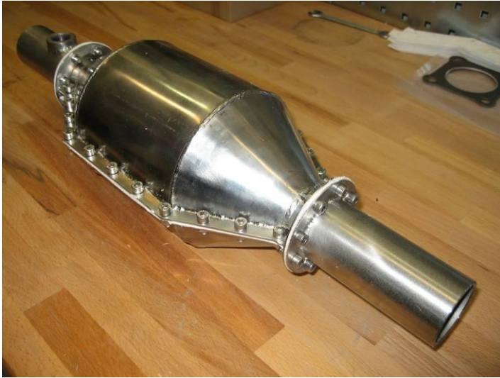
System ve smontovaném stavu, detail těsnění
