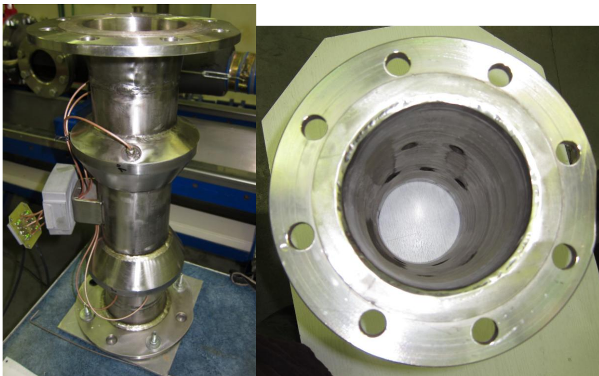
Obr.3: Funkční vzorek třípaprskového průtokoměru s připojenými sondami US 10.1 a detail jeho průtočné části
