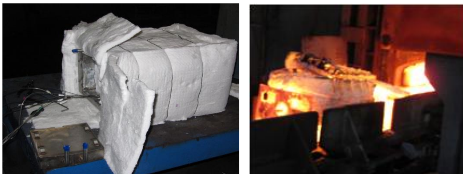
Obr.2: TBB-AMO/SJV při kompletaci a po výstupu z pece.
