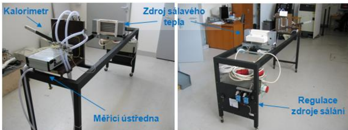
Obr.1: RadTester - zařízení pro testování materiálů při působení sálavého tepelného zdroje.
